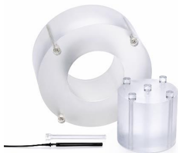
Фигура 6. РММА (Polymethyl methacrylate) за дозиметрична оценка при КТ и СВСТ.
